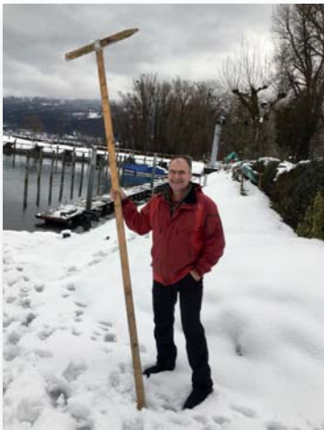
Peter Novak's Schneeschiebekonstruktion: lang genug, um vom Land aus arbeiten zu können. Damit wird ein Ausrutschen vom Steg verhindert.
